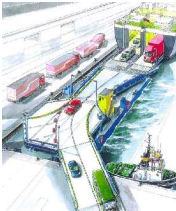
Abb.: Multifunktionale Fähranleger bilden eine flexible Alternative zu Fähranlegerrampen, die ausschließlich einem Schiffstyp angepasst sind.
