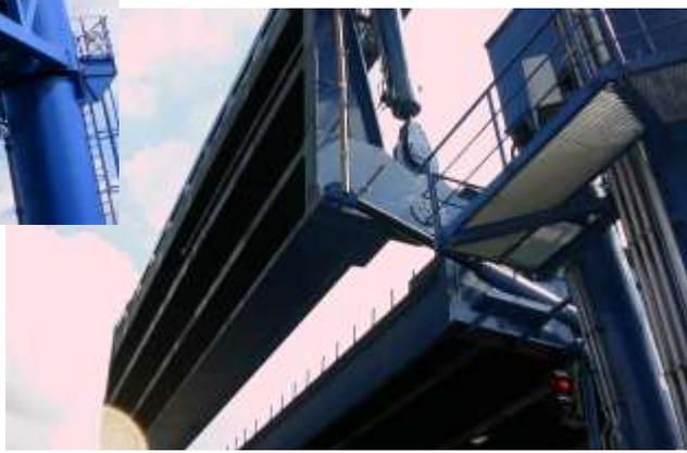
Abb.: Blick von unten auf die Oberdeckbrückenrampe
