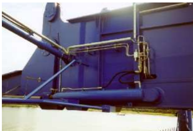
Abb.: Die Brückenzylinder werden von getrennten Pumpenströmen mit gleichen Ölmengen angetrieben, um einen hydraulischen Gleichlauf – unabhängig von der Belastung – zu gewährleisten.
